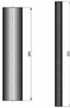
Tube inox Ø 21 mm longueur 300 mm avec tige filetée M8 21 mm Ø 300 mm long stainless steel tube with M8 threaded rod
